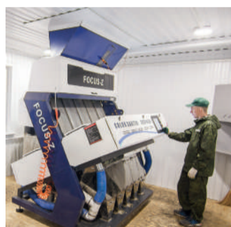
Финальная стадия очистки семян производится с использованием трех оптических сортировщиков, которые позволяют получать чистоту посевного материала 99,9%.
